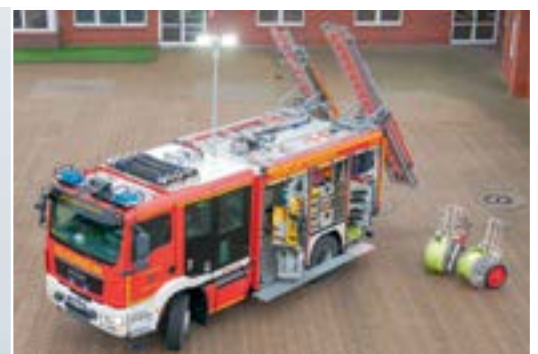
Auf einem MAN TGM 18.290 4x4 BB fertigte Schlingmann das neue HLF 20 der FF Nordenham.
