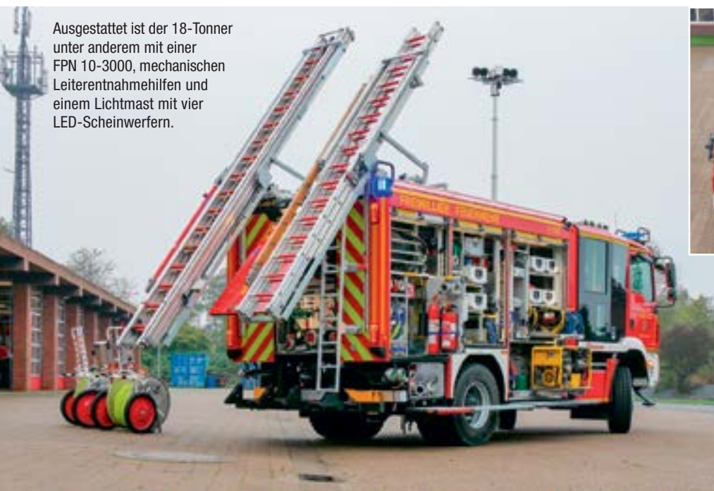
Auf einem MAN TGM 18.290 4x4 BB fertigte Schlingmann das neue HLF 20 der FF Nordenham.
