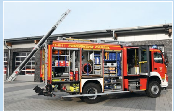
Für die tragbaren Leitern gibt es mechanische Entnahmehilfen. Drei pneumatische Trittstufen führen zur Mannschaftskabine.
