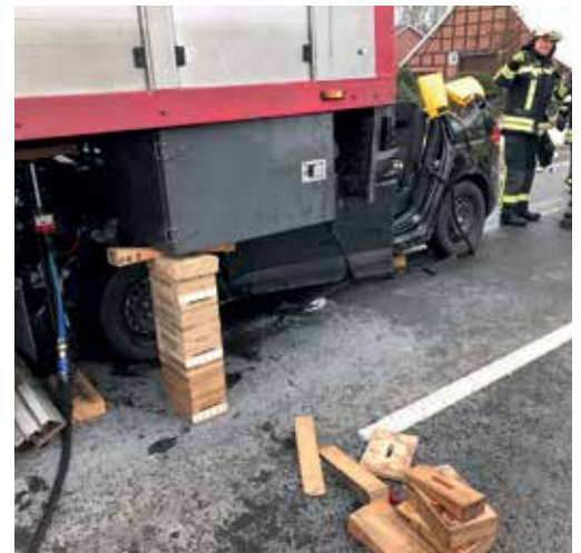
Die mitalarmierte Feuerwehr Vechna begann nach Eintreffen mit der Unterbauung und Anhebung des Aufliegers.
