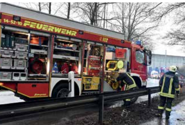
Vom Rüstwagen aus konnte die Seilwinde eingesetzt werden, um das Fahrzeugwrack vom Triebwagen zu trennen.
