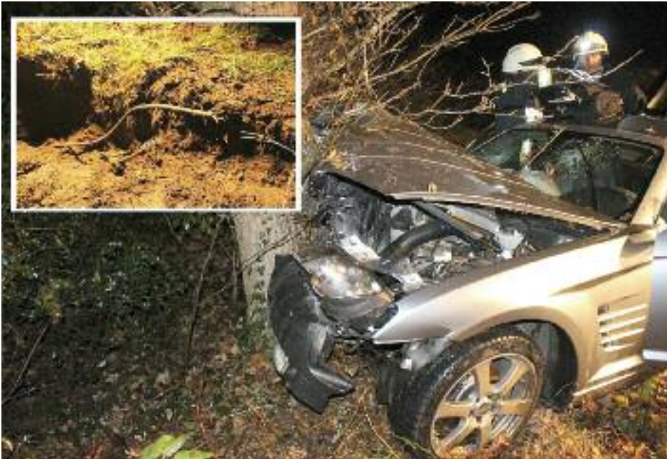
■ Nach dem Abklemmen der Fahrzeugbatterie wurden die abgerissenen Kabel (kl. Bild) der Straßenbeleuchtung isoliert.
