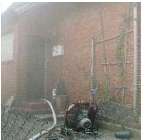
■ Zur Belüftung des Wohnhauses wurde ein Überdruckbelüfter schon während der Löscharbeiten eingesetzt.
