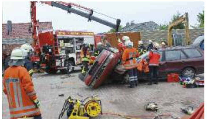
■ Gute Dienste leistete der Rüstwagen mit seinem Kran, womit die Unfallfahrzeuge angehoben und beseitigt werden konnten.
