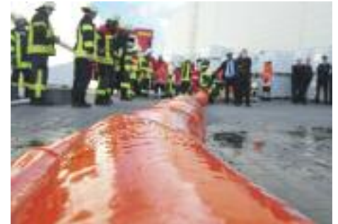
■ Das Öko-Tec System im Einsatz. Aus dem Folienschlauch lässt sich auch ein provisorisches Löschwasserreservoir bauen.
